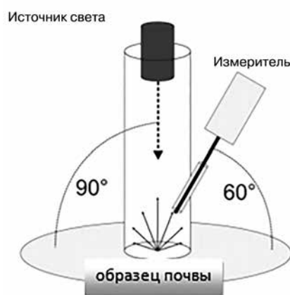
Рис. 2. Схематическое отображение модели формирования отраженного сигнала с увлажненной почвы: A — ход лучей при отражении Френеля с поверхности воды; B — ход лучей при отражении от частиц почвы
