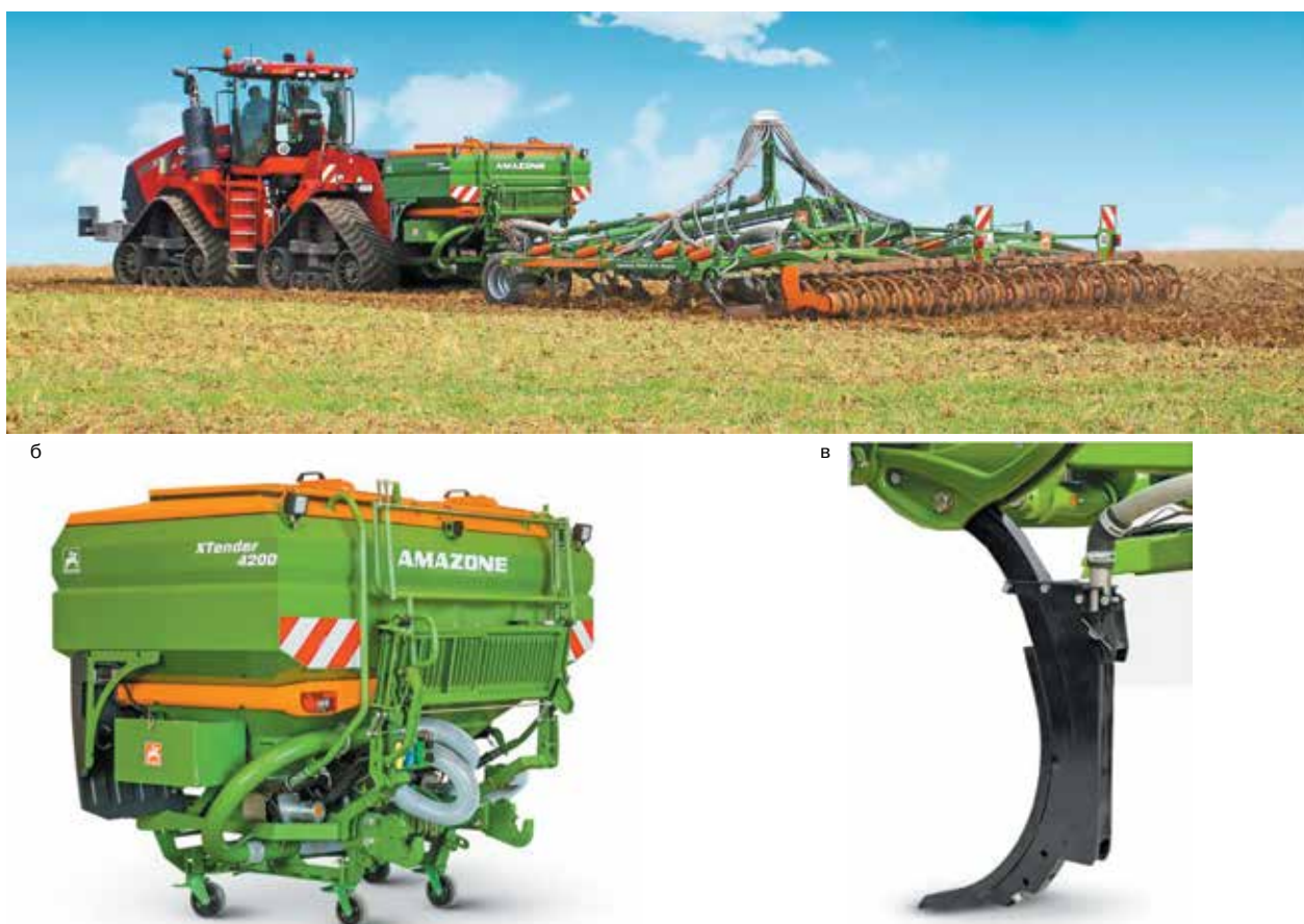
Рис. 1. а — комбинированный агрегат AMAZONE для внутрипочвенного внесения минеральных удобрений; б — навесной бункер для удобрений объемом 4,2 м 3 ; в — комбинированный рабочий орган культиватора Cenius для обработки почвы и внутрипочвенного внесения удобрений
