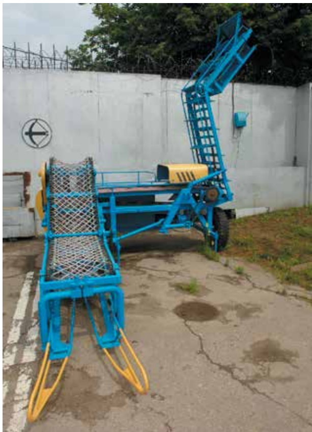
Рис. 2. Опытный образец нового капустоуборочного комбайна Fig. 2. A prototype of a new cabbage harvester
