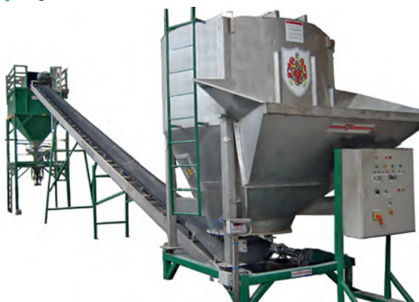
Рис. 10. Вертикальный смеситель 10 Fig. 10. Vertical mixer
