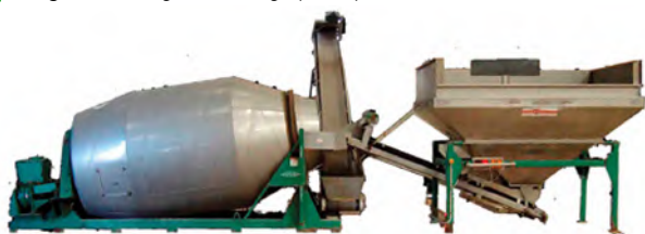
Рис. 9. Весовой смеситель непрерывного действия 9 Fig. 9. Rotating drum charge (batch) blender
