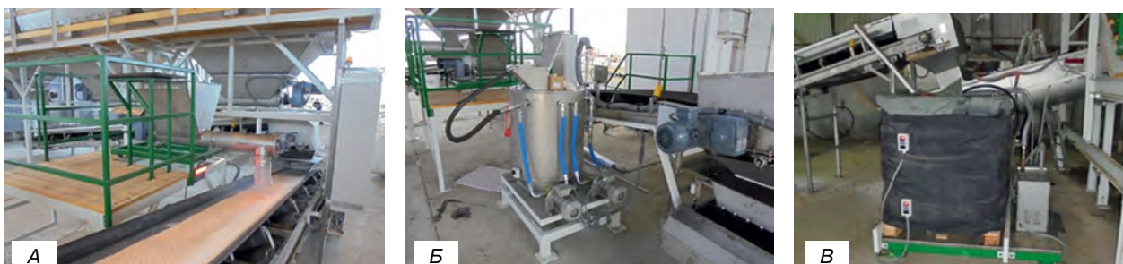
Рис. 13. Вспомогательные системы модифицирования тукосмесей: А — устройство для добавки сыпучих микрокомпонентов, Б — устройство для набрызгивания масла 14 , В — устройство для нанесения на гранулы минеральных удобрений кондиционирующих добавок 15 Fig. 13. Auxiliary systems for the modification of mixed fertilizer: А — device for adding bulk micro-components, В — a device for spraying oil 14 , С — a device for applying conditioning additives to mineral fertilizer granules 15
