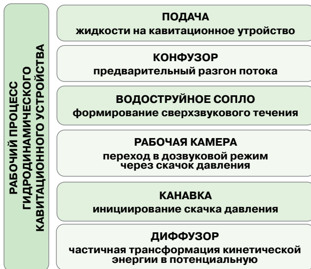
Рис. 1. Рабочий процесс кавитационного устройства со скачком давления
