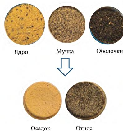
**Рис. 9.** Продукты после обрушения и пневмосепарации муки при переработке семян рапса по схеме рисунка 4 и выход продуктов на режиме 2. Фото авторов
