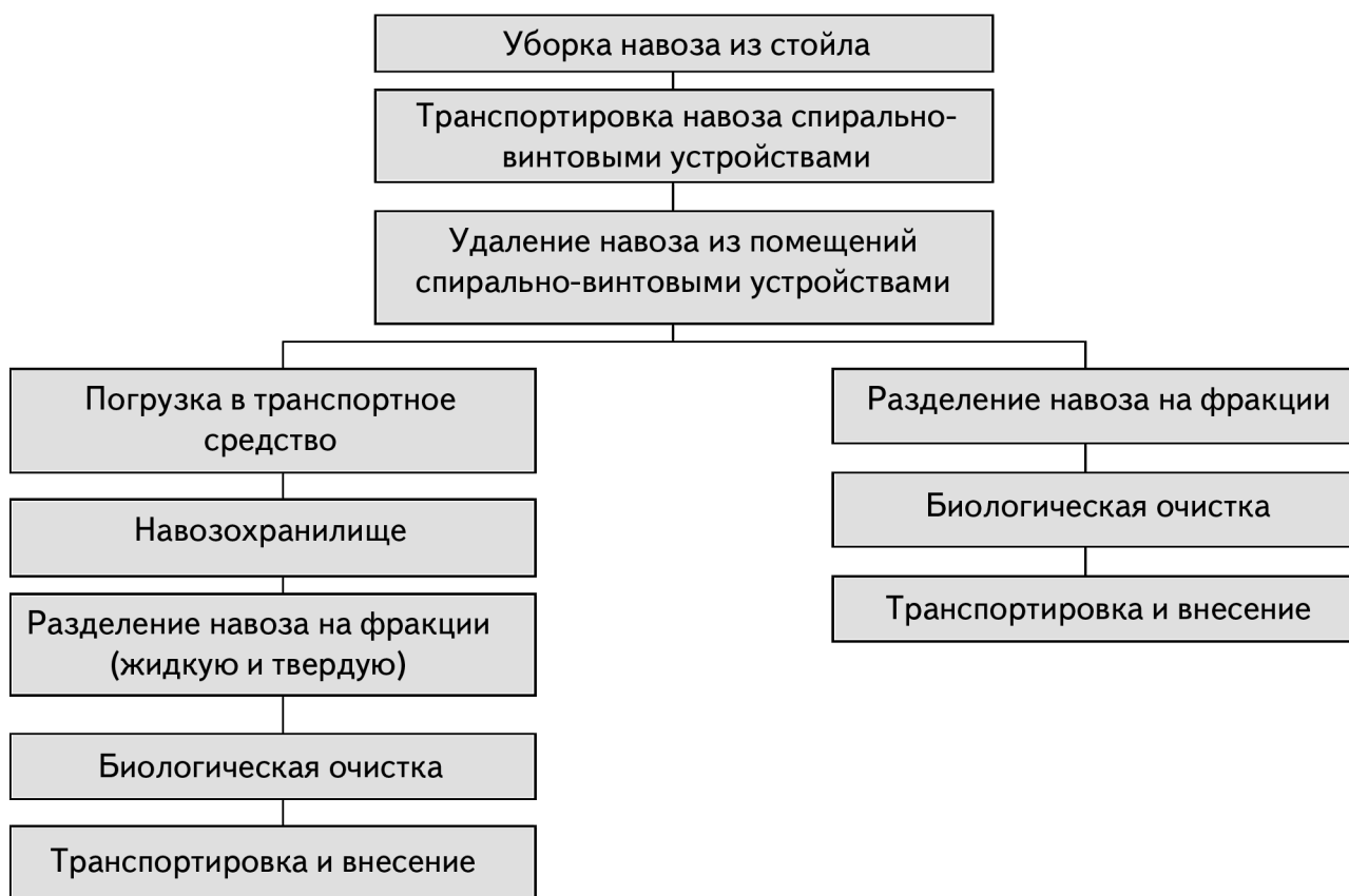
Рис. 3. Структурная схема технологического процесса по уборке, транспортировке и переработке навозной массы
