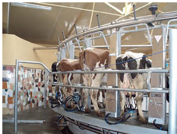
Рис. 3. Машинное доение в системе «карусель»
