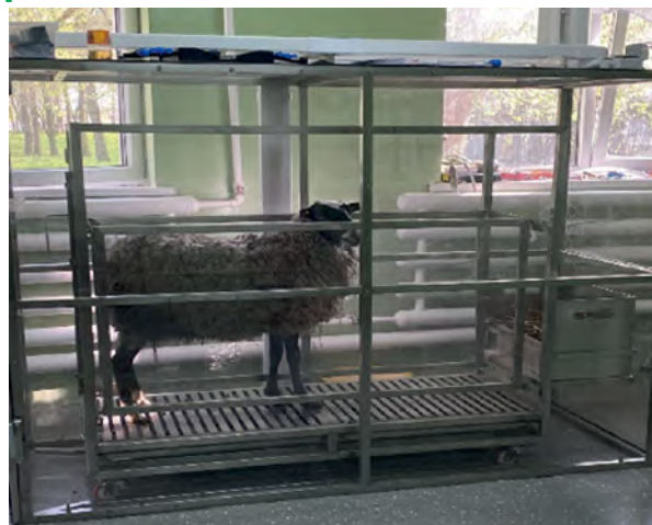
Рис. 1. Респираторная камера открытого типа Fig. 1. Open type respiratory chamber
