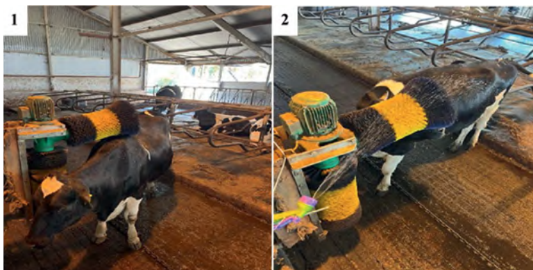
Рис. 2. Сухая (1) и влажная (2) очистка кожного покрова коров Fig. 2. Dry (1) and wet (2) cleaning of the skin of cows
