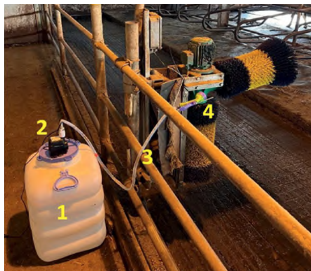
Рис. 1. Автоматическая щетка с устройством подачи воды: 1 — бак с водой; 2 — насос; 3 — шланг; 4 — распылитель
