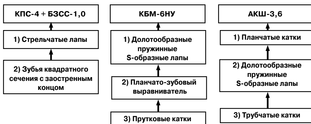
Рис. 2. Состав рабочих органов сельскохозяйственных машин, используемых для обработки почвы перед посевом овса Fig. 2. The composition of the working bodies of agricultural machines used for tillage before sowing oats
