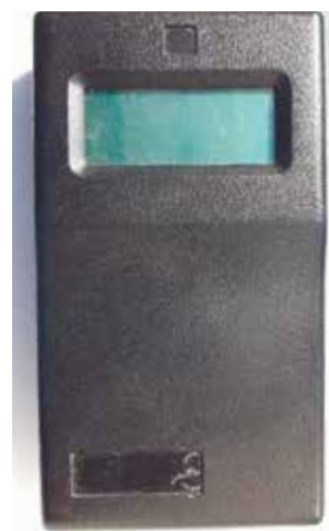
Рис. 3. Прибор, фиксирующий мерцание источника света
