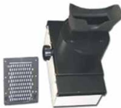
Рис. 2. Диафаноскоп Янтарь с кассетой
