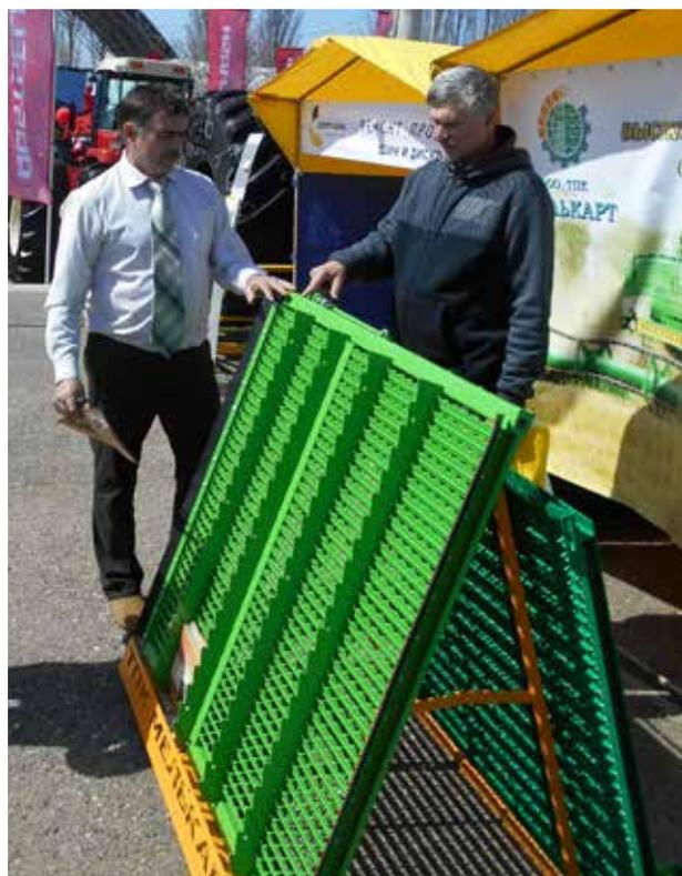
но и бесперебойно. Хорошо зарекомендовало себя и полимерно-порошковое покрытие деталей УВР-решет. Оно обеспечивает им повышенную износостойкость, а за счет упругости и эластичности значительно снижается повреждаемость зерна. По этой причине УВР-решета особенно эффективно используются в семеноводческих хозяйствах.
