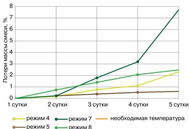
При режиме 5 наблюдалась аналогичная, по сравнению с режимом 4, динамика набора температуры: с 7,0 °С до 16,3 °С за первые сутки и до 22,1 °С за вторые сутки (рис. 9). Максимальная температура смеси составила 24,9 °С на 3 сутки биоферментации. Порог 55 °С при режиме 5 также не был достигнут. Потери массы смеси за период биоферментации составили 0,61% (рис. 9).
