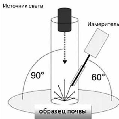
**Рис. 2.** Схематическое отображение модели формирования отраженного сигнала с увлажненной почвы: А — ход лучей при отражении Френеля с поверхности воды; В — ход лучей при отражении от частиц почвы
