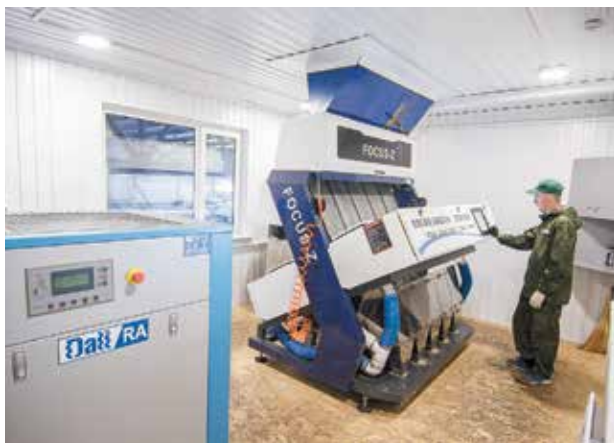
Работают две линии очистки семян с использованием оптических сортировщиков, которые позволяют добиваться чистоты продукта 99,9%
