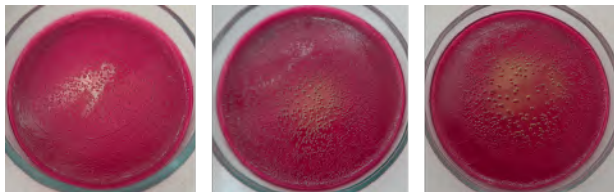
Рис. 3. Зоны ингибирования роста культуры Lactobacillus в контроле (слева) и после воздействия плазменной струи в течение t = 180 с (в центре) и 360 с (справа). Расстояние до сопла генератора h = 30 мм. Фото авторов
