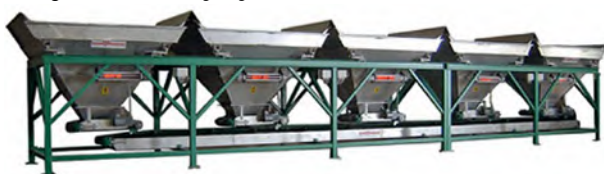
Рис. 9. Весовой смеситель непрерывного действия 9 Fig. 9. Rotating drum charge (batch) blender
