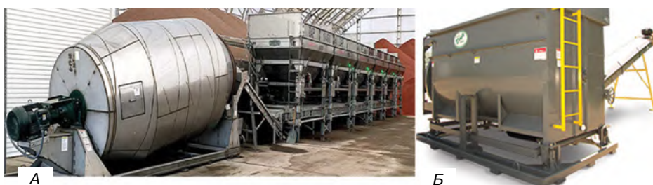
Рис. 14. Система смешивания AUTOBATCH А и лопастной смеситель Б 16 Fig. 14. AUTOBATCH mixing system A and paddle mixer B 16
