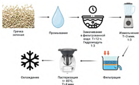
Рис. 1. Технология получения растительной дисперсии из семян Fig. 1. Technology for obtaining plant dispersion from green buckwheat
